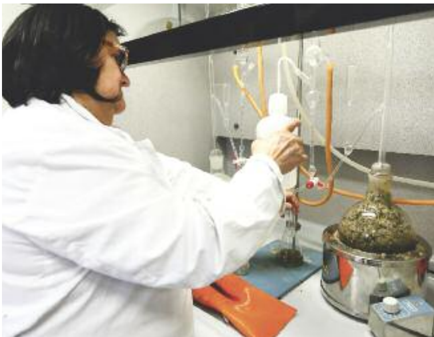
La destilación se lleva a cabo por arrastre de vapor en las instalaciones de la Fundación Térvallis
